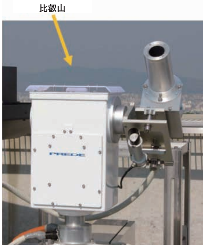
図1 太陽光近赤外スペクトル中のCO 2 吸収線強度からCO 2 カラム密度を計測する装置。背景に比叡山がうっすらと見えている。
